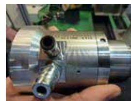
Die Biax RWA 2-22 Druckluftspindel verfügt über zwei Drucklufteingänge. So wird die Auslenkung der Spindel autonom gesteuert.
